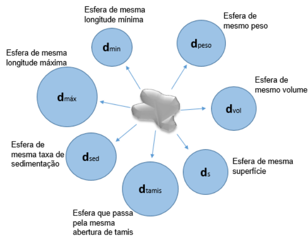
Figura 3 - Representação dos diferentes diâmetros por esfera equivalente que podem ser obtidos a partir de uma mesma partícula irregular
